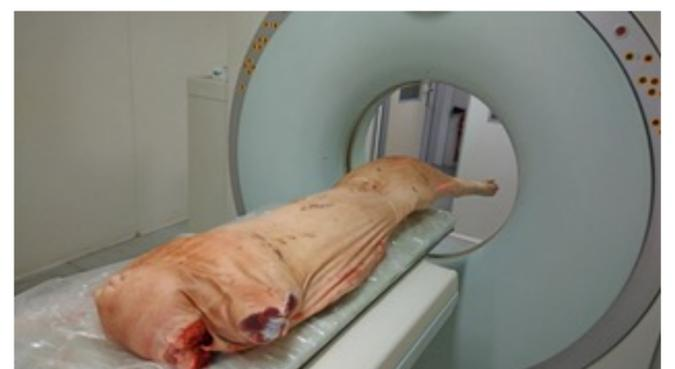
Fig. 2 : Scan d'une demi-carcasse par tomographie à rayons X
