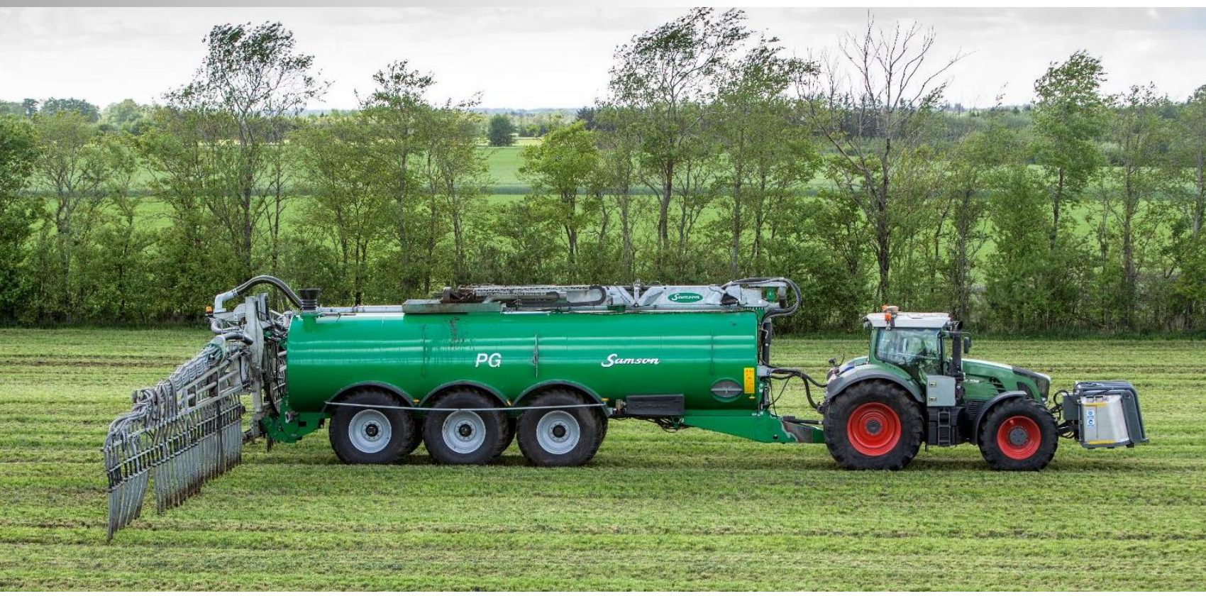
Système SYREN d'acidification à l'épandage danois commercialisé par Biocover
