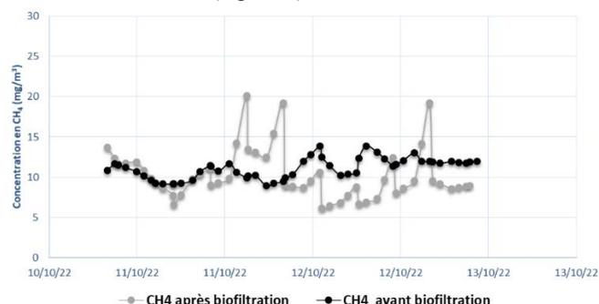
**Figure 2** - Concentration en méthane (CH<sub>4</sub>) avant et après biofiltration de l'élevage B en période froide
