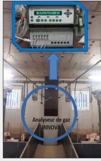
Figure 3 - Analyseur de gaz 1412 + échantillonneur d'air 1303 (INNOVA®)
