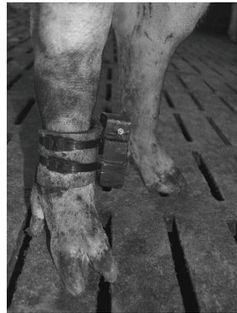
Figure 1 – Boîtier métallique contenant les accéléromètres, installé sur la patte arrière d'une truie.
