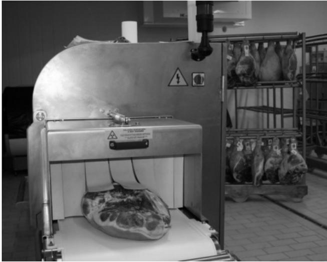
Figure 9 - Dispositif d'inspection à rayons X pour déterminer la teneur en sel des jambons
