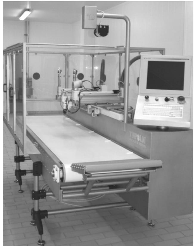
**Figure 5a** - Équipement pH120 dans les installations de l'IRTA-CENTA à Monells pour la classification de jambons selon le poids et le pH (TIMPOLOT, Olot, Girona). L'équipement dispose d'un système de vision artificielle qui permet, grâce à un bras robotisé, le positionnement de la sonde pH dans la zone de mesure prédéfinie. Les produits ainsi classés sont étiquetés pour garantir la traçabilité.
