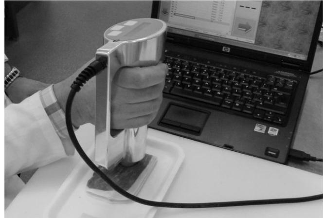
Figure 10 - Équipement Sequid RFQ-scan basé sur la spectrométrie micro-ondes
