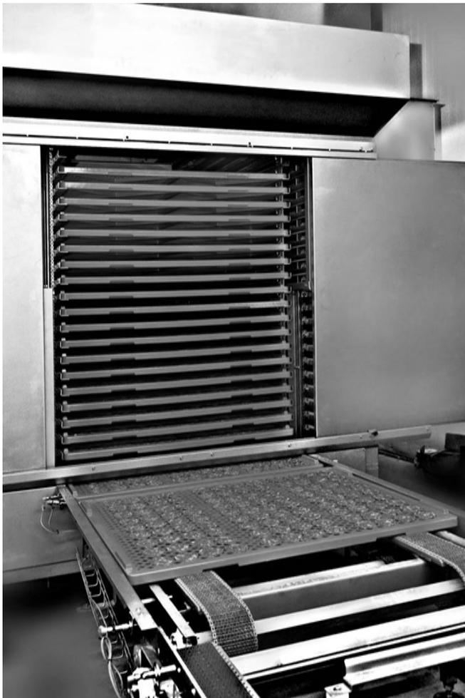
**Figure 1** - Plateaux de charcuterie tranchés entrant dans le tunnel de séchage QDS process® (Metalquimia, S.A. et Casademont, S.A.)
