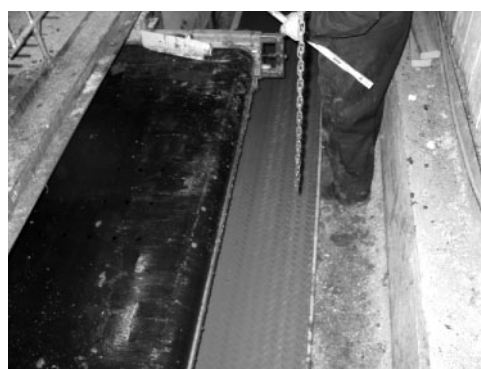
Figure 1 - Système de courroie séparant les fèces et l'urine sous le caillebotis
